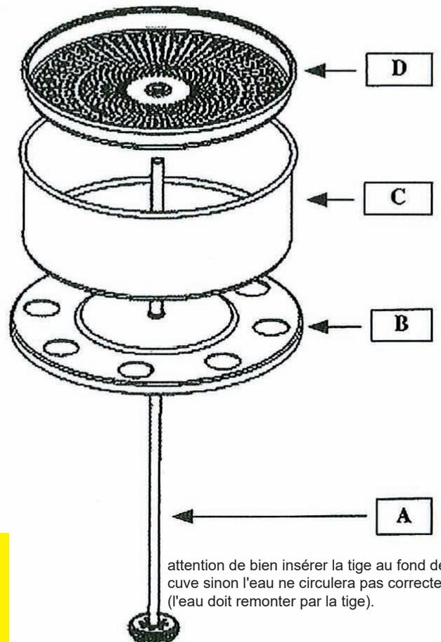
attention de bien insérer la tige au fond de la cuve sinon l'eau ne circulera pas correctement (l'eau doit remonter par la tige).
